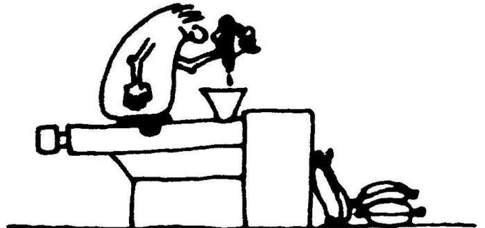
17°/ Mettre progressivement l'extrudeuse au régime indiqué et introduire le profilé dans les outillages de conformation, de refroidissement... jusqu'au tirage.
