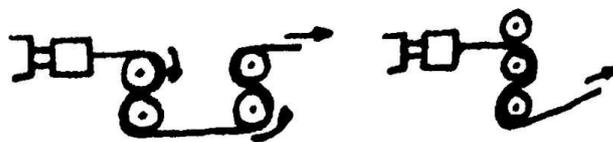
Après refroidissement, la feuille est tirée par deux rouleaux caoutchoutés, situés à 1 ou 3 m des précédents. Dans l'intervalle, la feuille peut être supportée par de petits rouleaux et son refroidissement complété par des ventilateurs.
