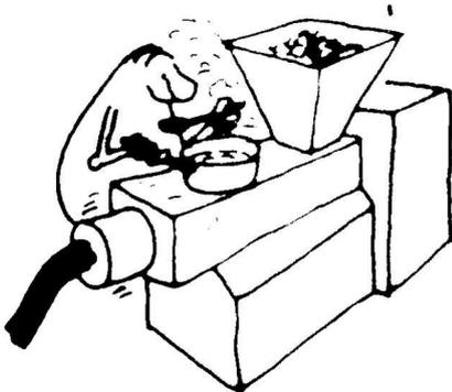
Il faut noter que les extrudeuses polytropiques se comportent également dans une certaine mesure en extrudeuses adiabatiques. En effet, les calories nécessaires à la gélification sont apportées dans une proportion variable par l'énergie thermique extérieure et par les frictions internes.
